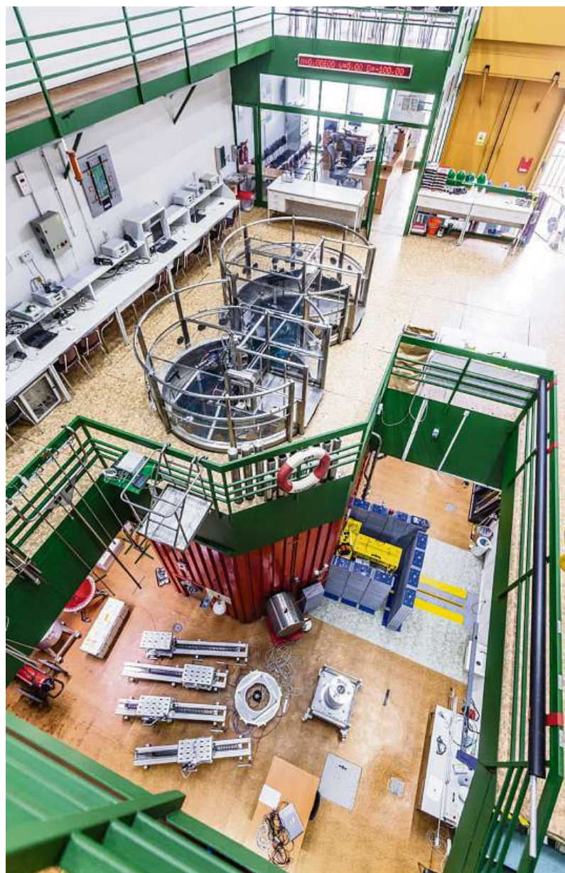
Jaderný reaktor VR-1 Vrabec provozovaný FJFI v Troji nepotřebuje chladič věž, jeho výkon je totiž menší, než má běžná rychlovarná konvice.
